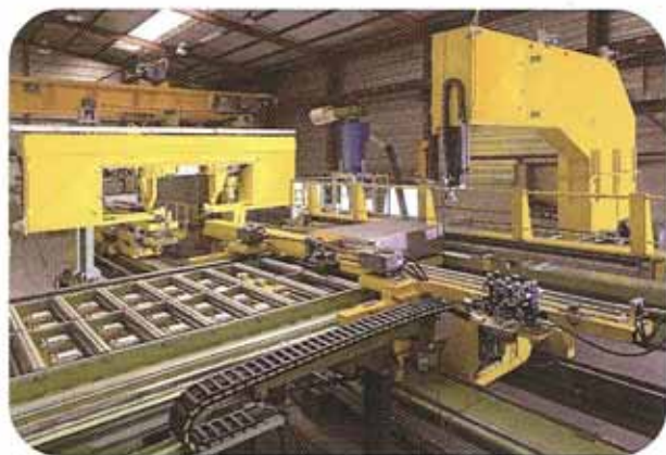
Installation de sciage et refendage de blocs d'aluminium de grandes dimensions
